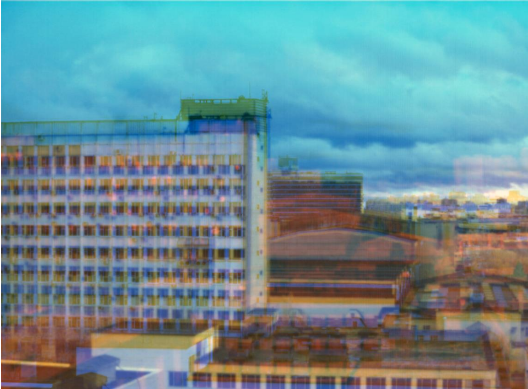
Фиг. 1. Комплексование (попиксельное слияние) ТВ, ближнего ИК и ТП видеоканалов без совмещения.
