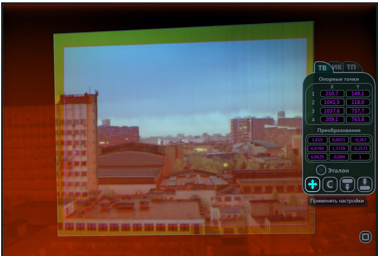
Фиг. 3. Вариант реализации процесса совмещения изображений по предлагаемому способу. Вкладки «ТВ», «ИК», «ТП» – определяют, изображение от какого видеоканала совмещают путём перемещения выбранных точек его текстуры. «Опорные точки» – координаты четырёх опорных точек изображений в пиксельных координатах эталонного изображения для совмещения. «Преобразование» – вычисленная матрица преобразования гомографии выбранного изображения видеоканала. Радиокнопка «Эталон» – назначает видеоканал эталонным. Нижний ряд кнопок на управляющей панели слева направо: «применить настройки». «сбросить настройки», «загрузить настройки» и «сохранить настройки».
